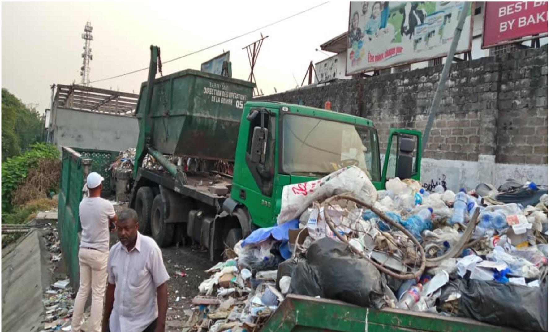
**Une multi benne en action dans une Station de transfert**
