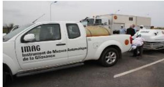
**IMAG: mesure automatique de la glissance**
