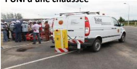
**RADAR : mesure des épaisseurs des couches de structure de chaussée**
