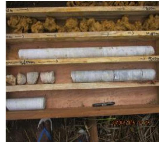
**Les PDB permettent d'apprécier d'une façon qualitative la résistance de Terrains traversés**
