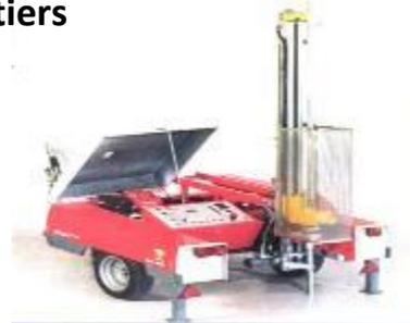
**PDG 1000 :contrôle de compactage des remblais**
