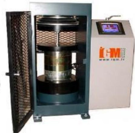
**Presse béton de 3000 KN**
