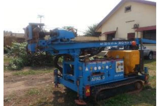
**Sondeuses puissantes et polyvalentes pouvant opérer en carottage, rotation et roto percussion grâce à leur marteau hors trou, idéale pour la géotechnique.**
