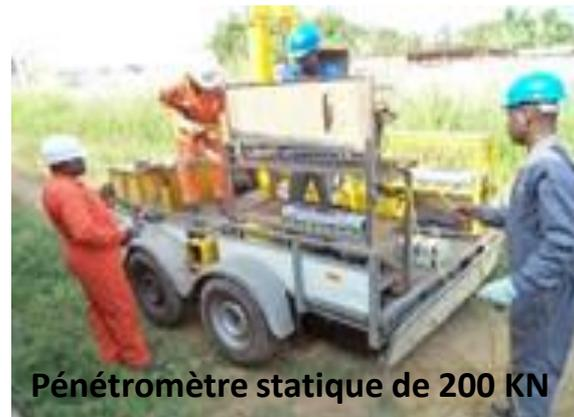
Pénétrromètre statique de 200 KN
