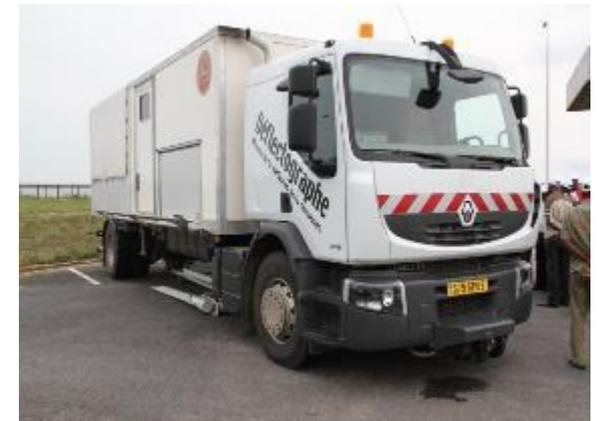
**DEFLECTOGRAPHE LACROIX : mesure de la déflexion de la chaussée.**
