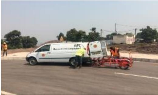
**APL : mesure du profil en long ou l'UNI d'une chaussée**
