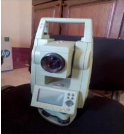
**Station Totale :Permet de mesurer des angles horizontaux et verticaux en grade via des cercles gradués.**
